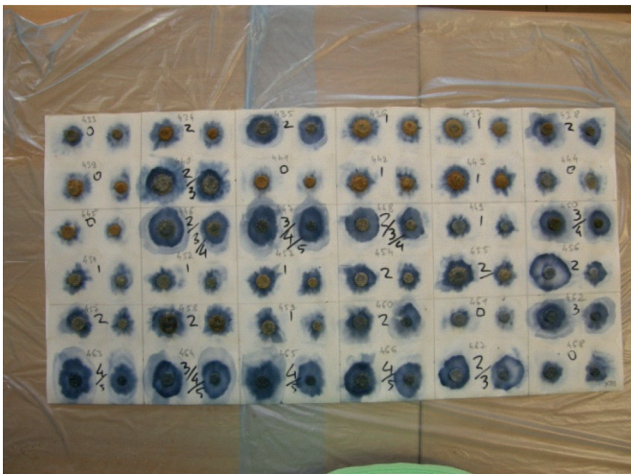
Ryc. 10. Oznaczanie zawartości fosforu w próbkach uproszczoną metodą polową.
