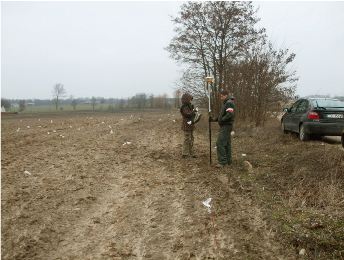
Ryc. 5. Wykorzystanie odbiornika GPS RTK w czasie szczegółowej inwentaryzacji źródeł archeologicznych na powierzchni stanowisk.
