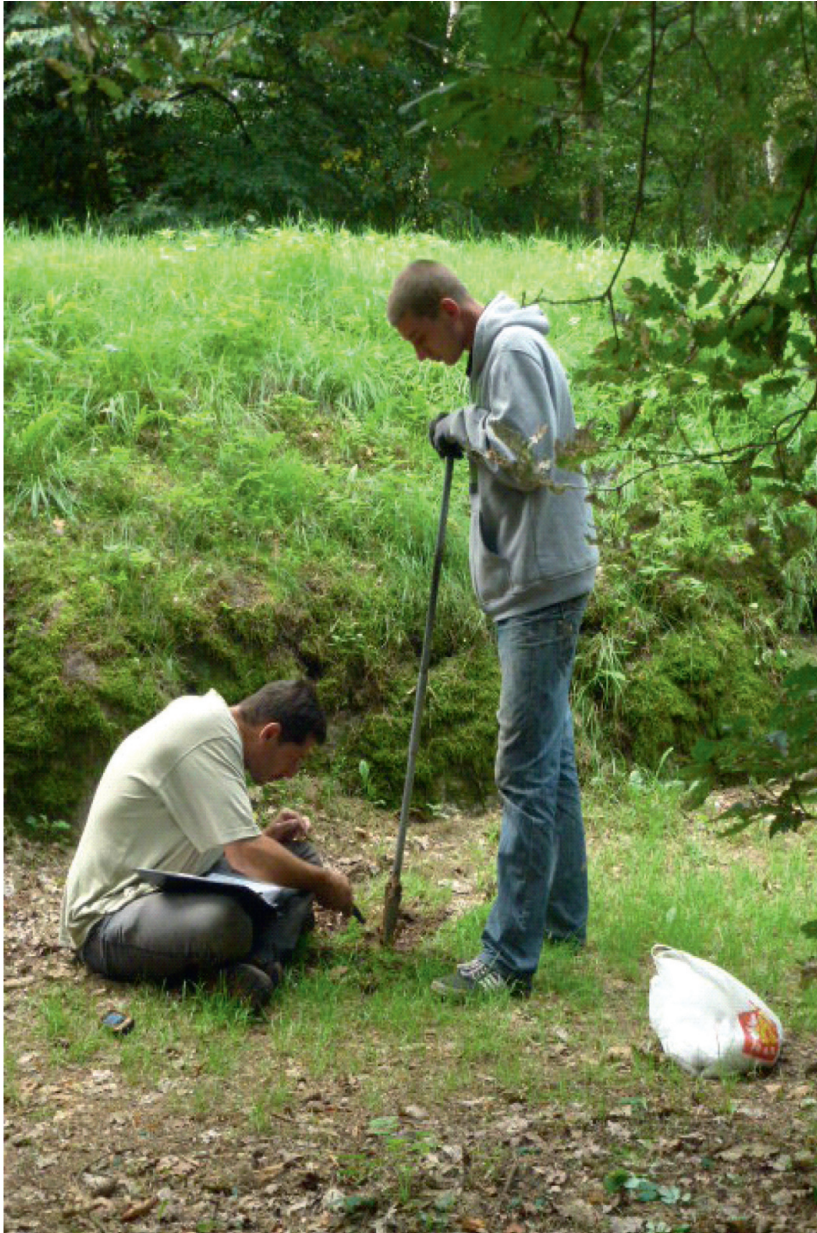
Ryc. 9. Pobór próbek do badań geochemicznych z użyciem ręcznej sondy geologicznej Eijkelkamp zaopatrzonej w świder Edelmana typu kombi. Fig. 9. Collecting samples for geochemical research by means of a hand geological probe Eijkelkamp, equipped with Edelaman drill, combi type.
