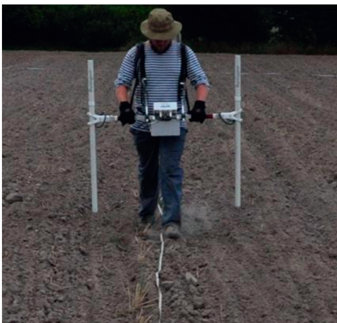
Ryc. 7. Prospekcja magnetyczna instrumentem pomiarowym Bartington Grad601-2. Fig. 7. Magnetic prospectation conducted with measuring instrument Barington Grad601-2.
