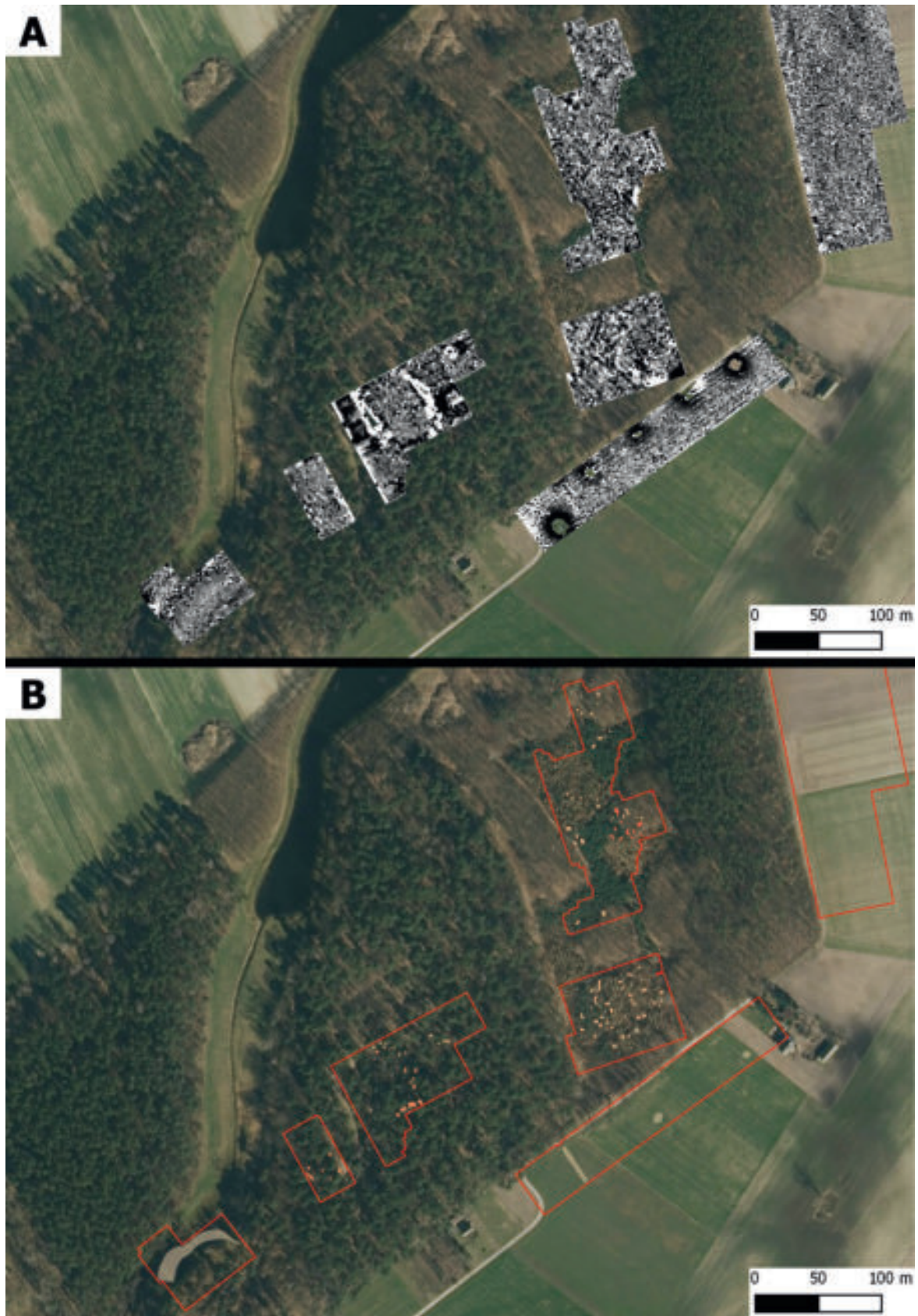
Ryc. 55. Park Kulturowy Wietrzychowice. A – wizualizacja pomiarów magnetycznych w skali szarości (-2/2nT, biały/czarny); B – archeologiczne mapowanie anomalii magnetycznych (odcienie koloru czerwonego).
