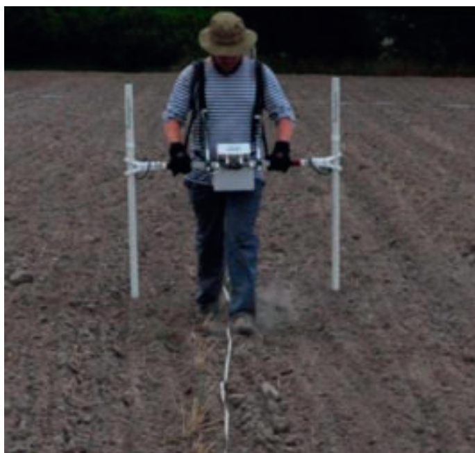
Ryc. 7. Prospekcja magnetyczna instrumentem pomiarowym Bartington Grad601-2. Fig. 7. Magnetic prospection conducted with measuring instrument Barington Grad601-2.
